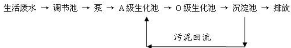
图 4.1-10 生活污水处理工艺流程图
