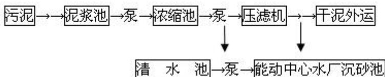
图2-8 污泥处理站工艺流程图
