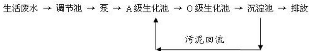
图2-9 生活污水处理工艺流程图
